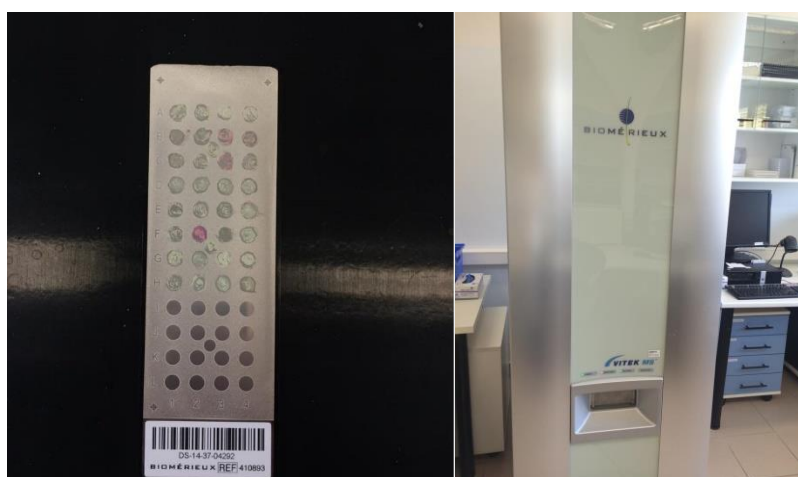
Obr. 7 – destička na MALDI-TOF Obr. 8. Přístroj VITEK MS
