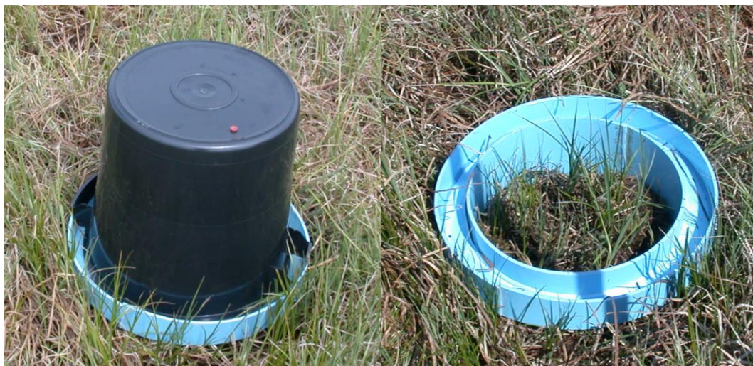
Foto 2. Vlevo kompletní odběrová komora, vpravo žlábek komory.
