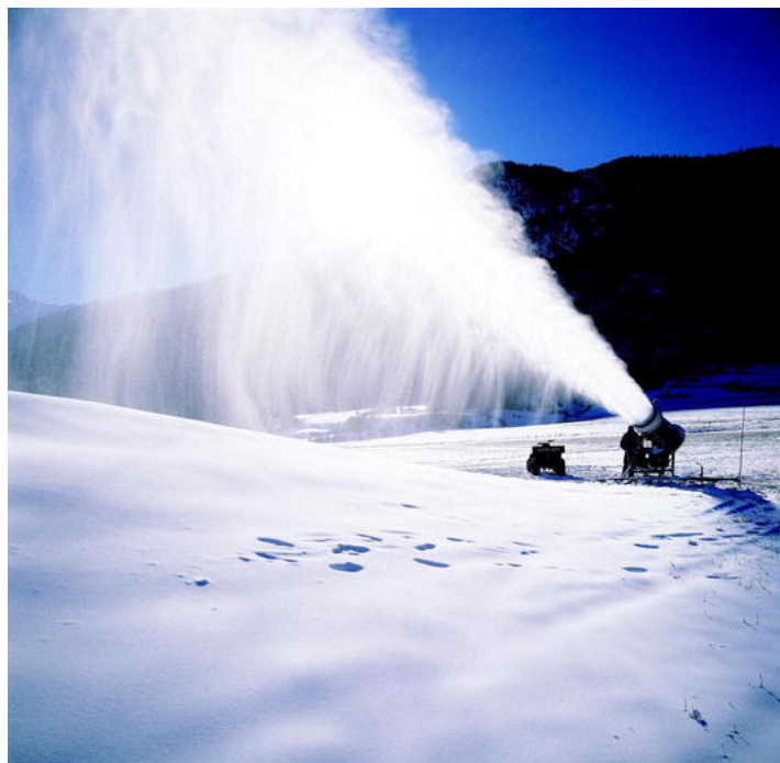
Obr. 6. Přenosné sněžné dělo (převzato z ELSASSER & MESSERLI 2001).
