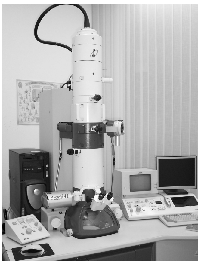
Obr. 4. Transmisní elektronový mikroskop JEOL 1010.
