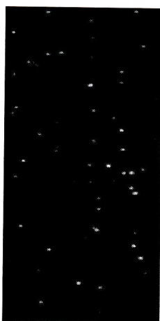
Obrázek v30: Zobrazení fluorescence fotosystému I na křemenném skle koncentrace 10^{-6} . Na obrázku jsou opět velice dobře rozlišitelné jednotlivé molekuly, výřez 50 x 50 pixelů. OD 2, integrační čas 15 s, štěrba 2 mm.
