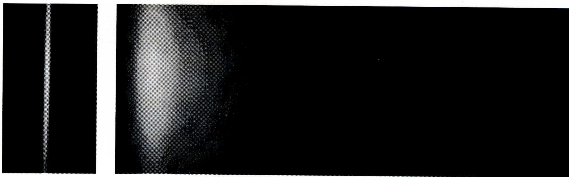
Obrázek v14: Vlevo obrázek úzké štěrbině (bez jednotlivých molekul). Štěrbina 0,1 mm, integrační čas 10 s, OD 4. Vpravo obrázek spektra na celém čipu CCD. Štěrbina 0.1 mm, centrální vlnová délka 625 nm, integrační čas 60 s, OD 4.
