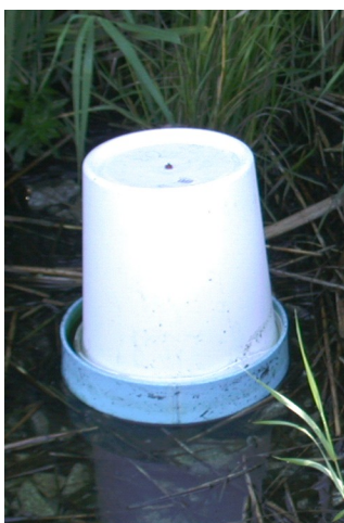
Obr. 6: Odběrová komora pro měření plynů unikajících přes vodní hladinu.
