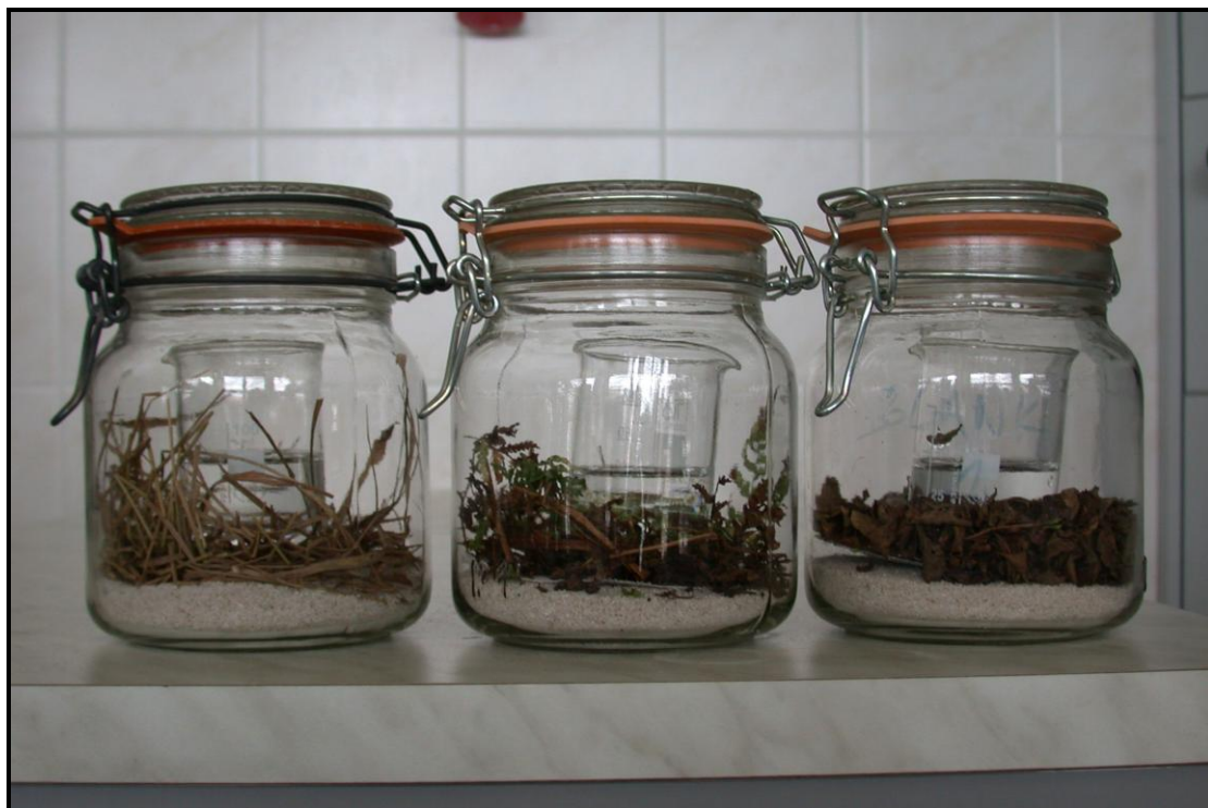
Obrázek č. 5: Inkubační lahve s rozkládajícími se opady a kádinkou s 1M NaOH.
