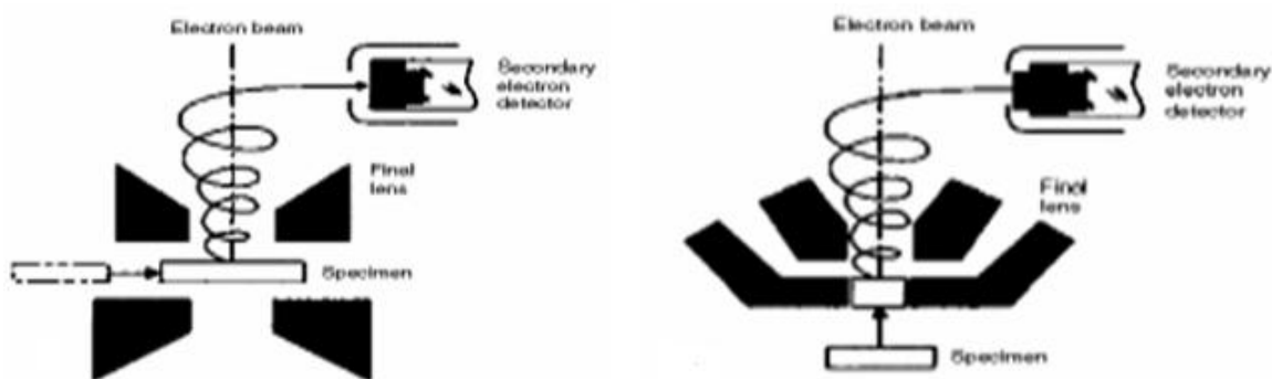
Obrázek č. 19: Umístění vzorku ve FESEM (in – lens je znázorněno vlevo, below – the – lens vpravo) [9]
