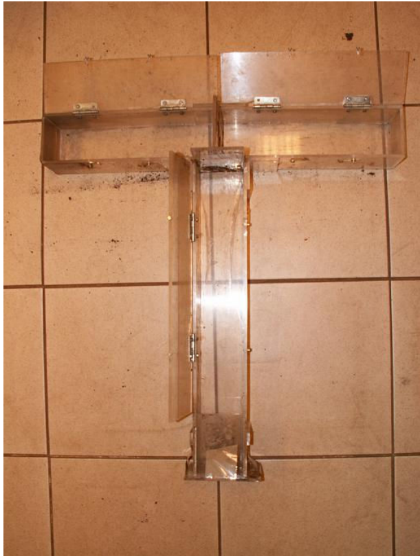
Obr.2: Testovací aparatura – preferenční kříž
