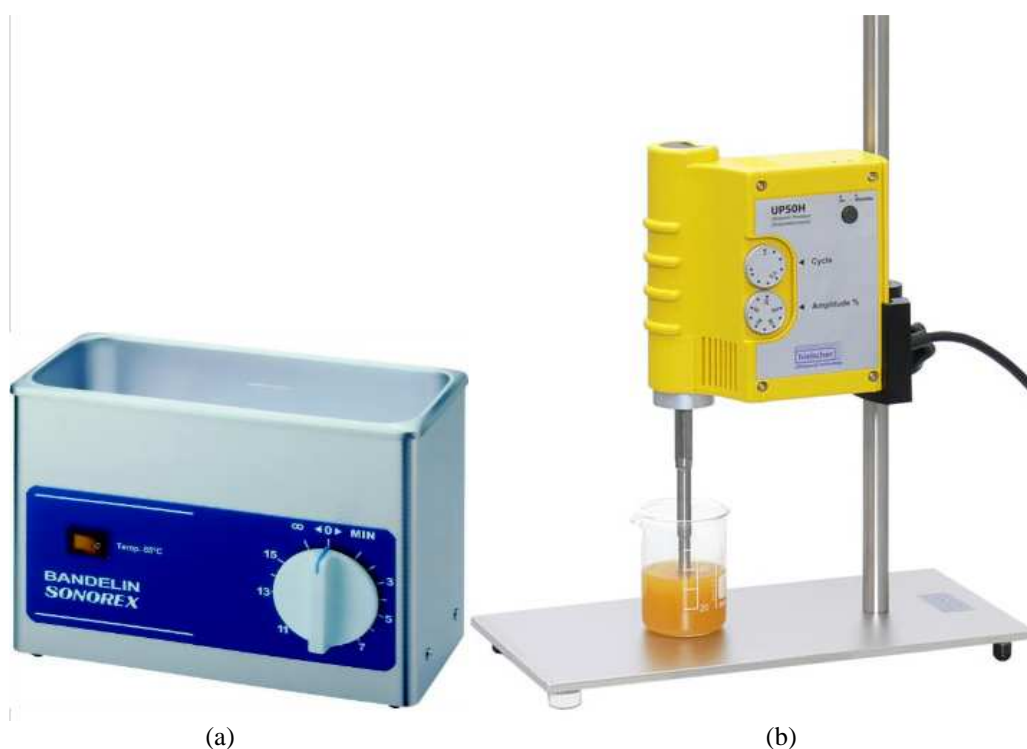
Obr. 4. Příklady sonikačních zařízení a) sonikační lázeň typ Sonorex RK52 (Bandelin, Německo) b) sondový sonikátor typ UP50H (Dr. Hielscher, Německo)
