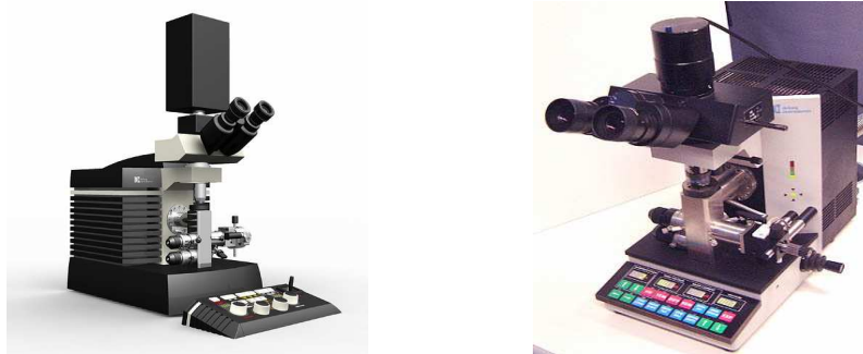
Obr.1. Nový a starší prototyp nízkonapěťového elektronového mikroskopu LVTEM5.
