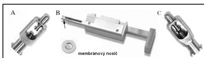
Obrázek 11: Podávací a transportní příslušenství používané v RTS jednotce přístroje Leica EM PACT2. A. Horní část transportního bajonetu pro rychlé mražení v RTS s malým nastaveným otvorem. B. Rychlý podávací nástavec pro nosiče preparátů s membránovým nosičem zabudovaným uvnitř nástavce (šipka). C. Uzavřená horní část transportního bajonetu s nosičem preparátu uvnitř po kryofixaci (Müller-Reichert a kol., 2006; upraveno).
