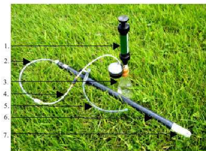
Obrázek 3: 1. Vakuová pumpa, 2. 10mm hadice vedoucí z vakuové pumpy 3. Vzorkovací nádoba 4. 5mm vzorkovací hadička 5. Prodloužení vakuové hadičky 6. PVC trubka 7. Keramický kalíšek
