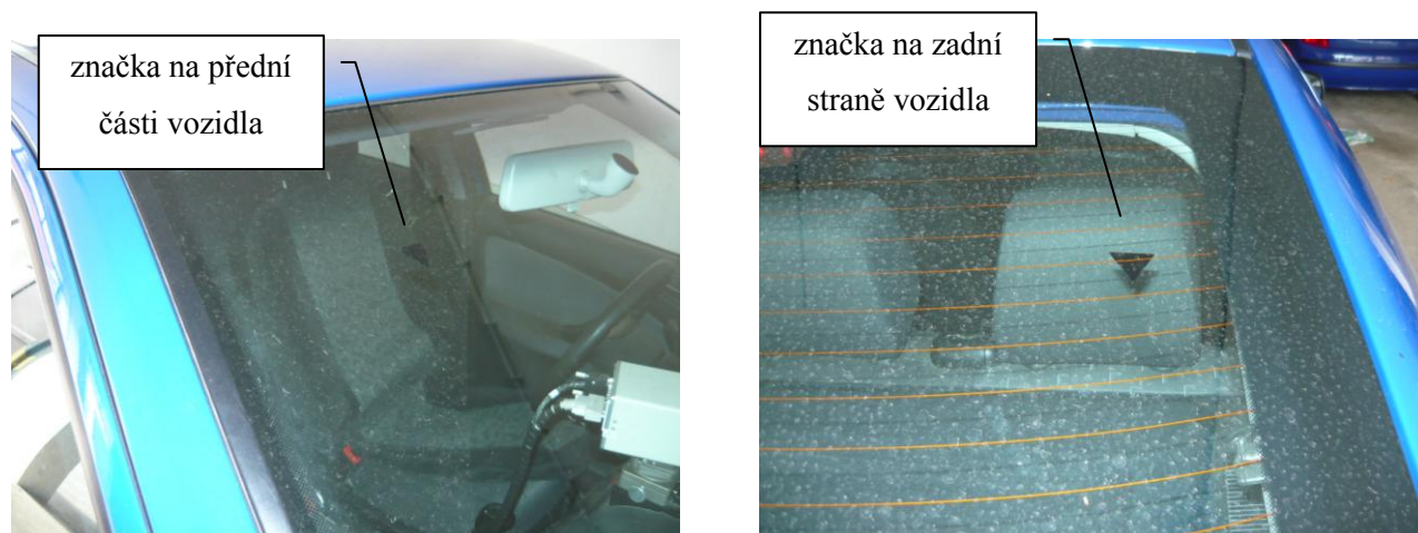
Obrázek č.6: Orientační značky na vozidle systému AD9 C, které napomáhají přesnému postavení na stanovišti k dodržení max. úhlu 22°
