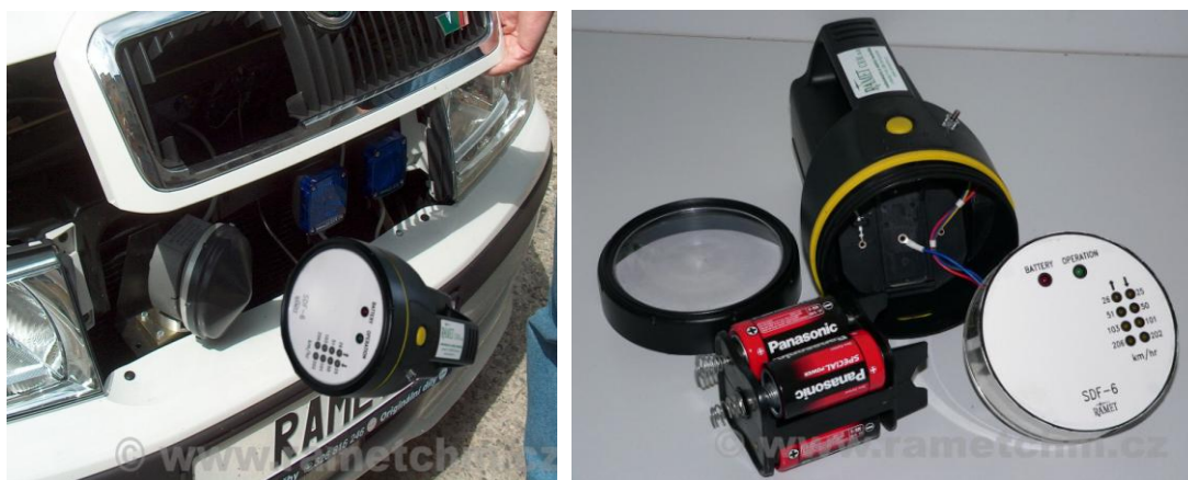
Obrázek č.14: Simulátor radiolokačních vln k ověření správné funkce měřiče rychlosti
