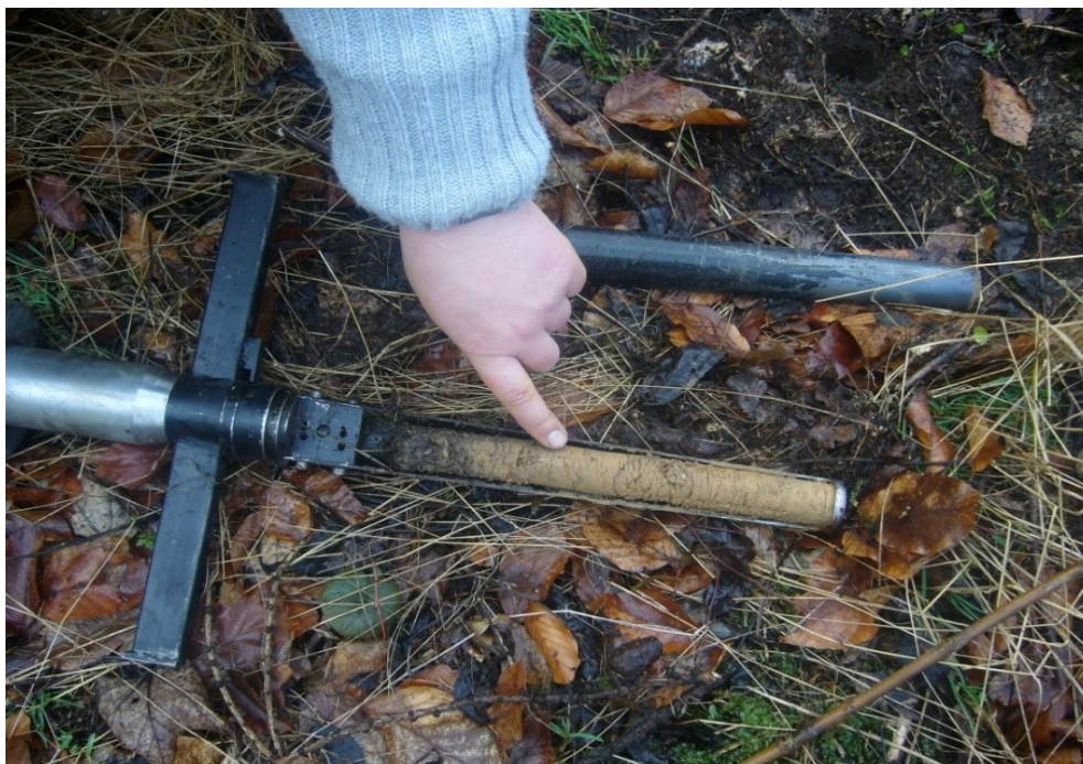
Obr. 5: Sonda pro odebrání půdy s vyznačenou stupnicí
