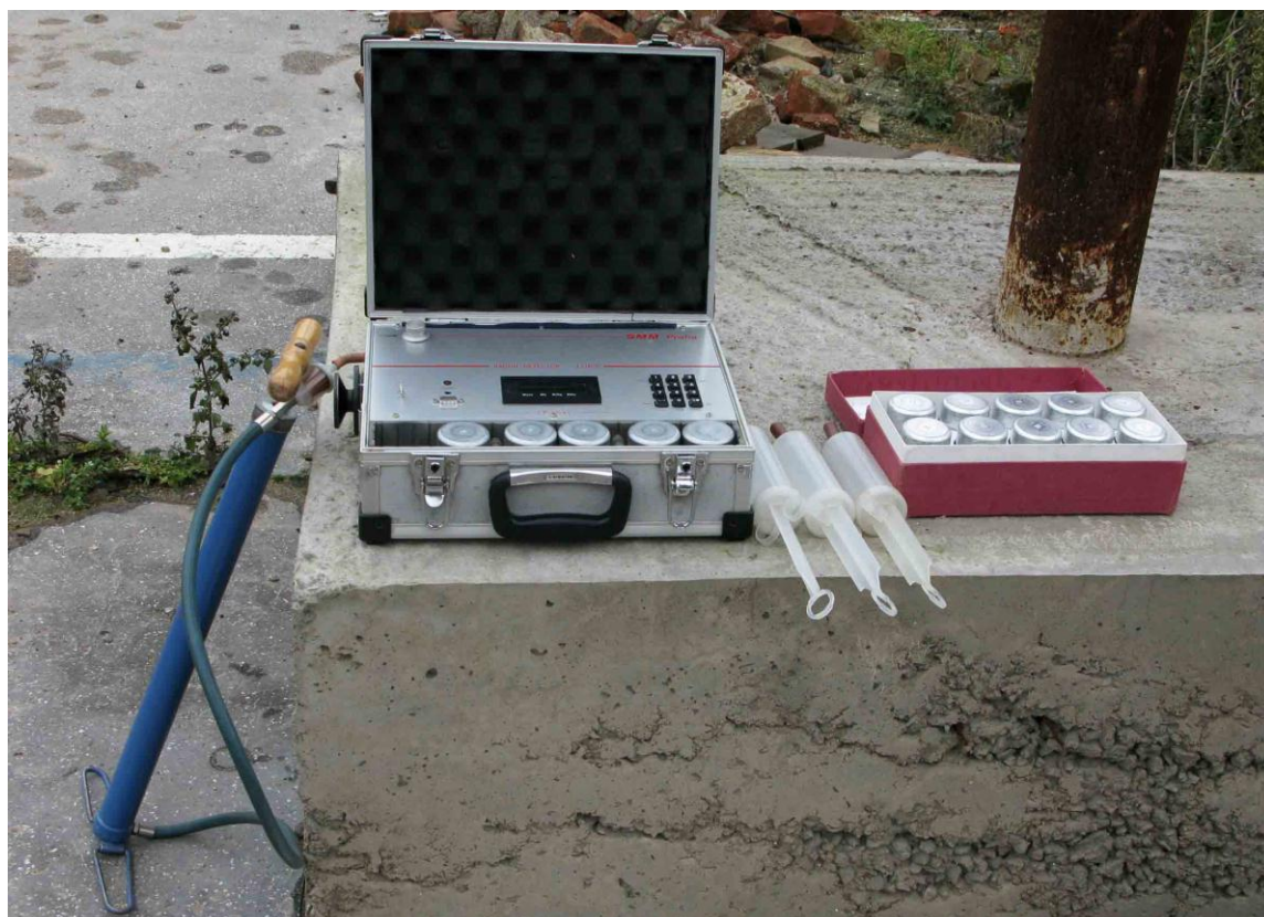
Obrázek. č. 5.2: Souprava pro měření. Zleva: ruční pumpa, přístroj LUK 3R, stříkačky Janneta, Lucasovy komůrky. Zdroj[11]
