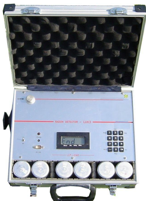
Obrázek č. 5.1: Přístroj na měření radonu LUK 3R. Zdroj [11]
