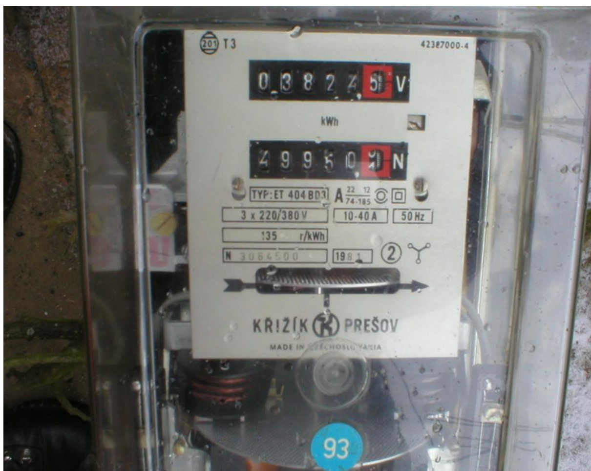
Obrázek 3: Příklad fotografie analogového dvousazbového elektroměru
