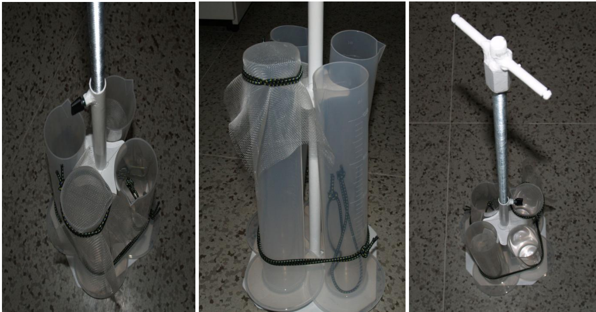
Obrázek 8. Odměrné válce v nosné konstrukci určené pro sledování vyplouvání cercárií z měkkýšů na sledované lokalitě.
