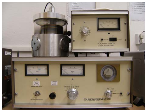
Obrázek 19. Iontová napařovací aparatura Polaron Equipment LTD SEM Coating unit E5100
