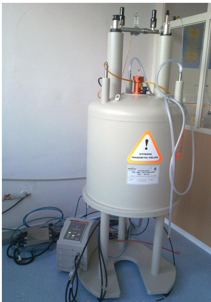
Obr. 26: 300 MHz NMR spektrometr s vsunutou sondou. V sondě je umístěna kyveta se vzorkem.
