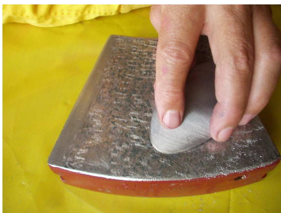
Obr. 8: Detail přípravy segmentů patního ložiska (zaškrabávání kompozice).
