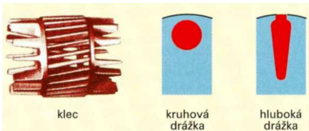
Obr. 16 Klecová kotva bez rotorových plechů a tvary drážek, převzato a upraveno z [7]
