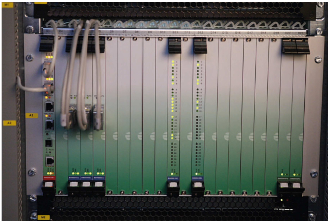
Obr. 5 Modulární provedení PLC od firmy ZAT a.s., převzato a upraveno z [4]
