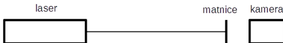
Obr. 4.3.1: Schéma sestavy při měření profilu He-Ne laseru.
