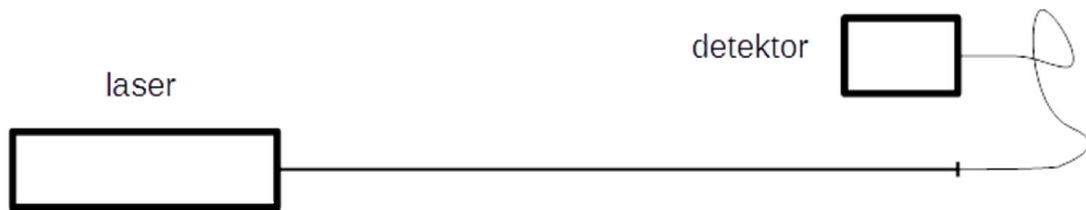
Obr. 4.1.1: Schéma sestavy při měření vlnové délky He-Ne laseru.
