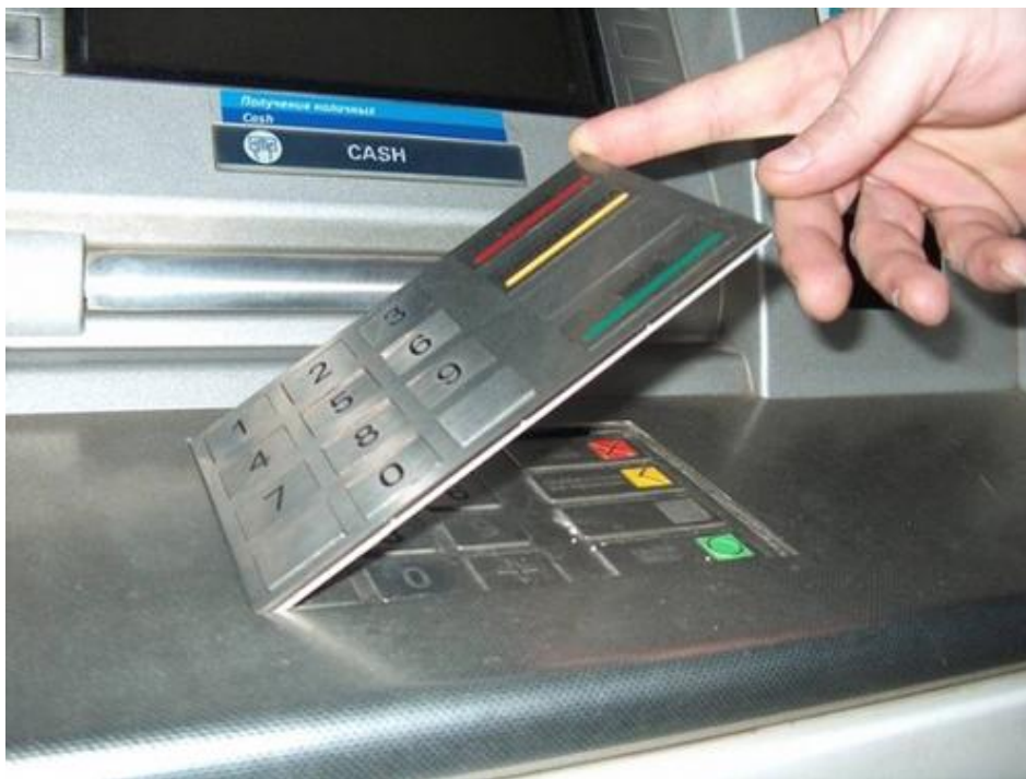
Obrázek 10: Původní klávesnice překrytá PIN Padem pachatelů
