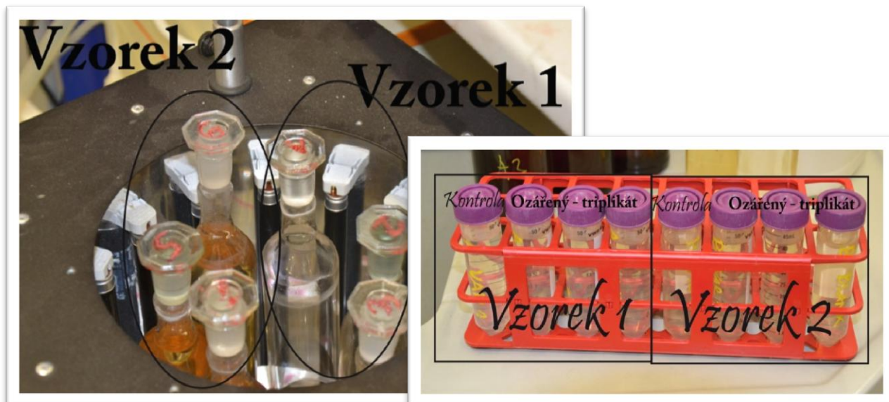
Obrázek 3: Ozařované vzorky v křemenných lahvích nalevo, ozářené vzorky připravené k přidání ^{33}\text{P} napravo.
