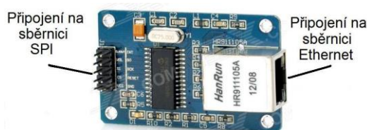
Obr. 4 - ethernetový modul s ENC28J60 převzato a upraveno z [16]
