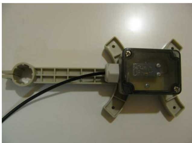
Obr. č. 44 – Čidlo nahrazené technickou krabicí PC 75-4-tv
