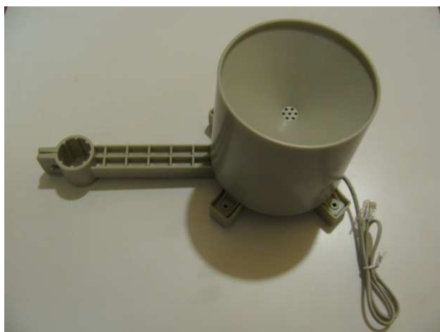
Obr. č. 43 – Čidlo pro měření četnosti srážek u vnější jednotky k meteostanici WH5027
