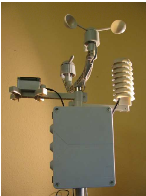
Obr. č. 45 – Zařízení pro měření vnějších klimatických podmínek
