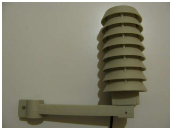
Obr. č. 26 – Zkompletovaný díl pro měření teploty a vlhkosti
