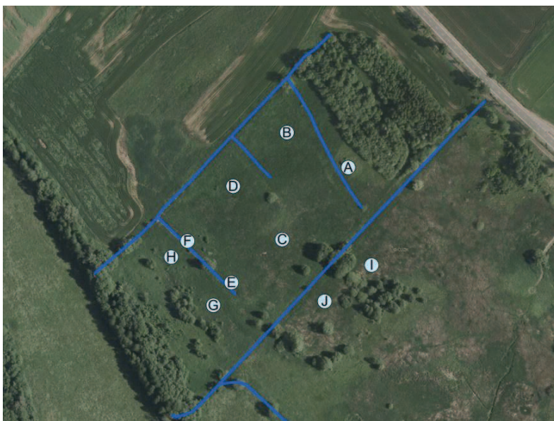
Obr. 27: Rozmístění sond (perforovaných trubek) na měření hladiny podpovrchové vody v terénu s vyznačením odvodňovacích kanálů. 30
