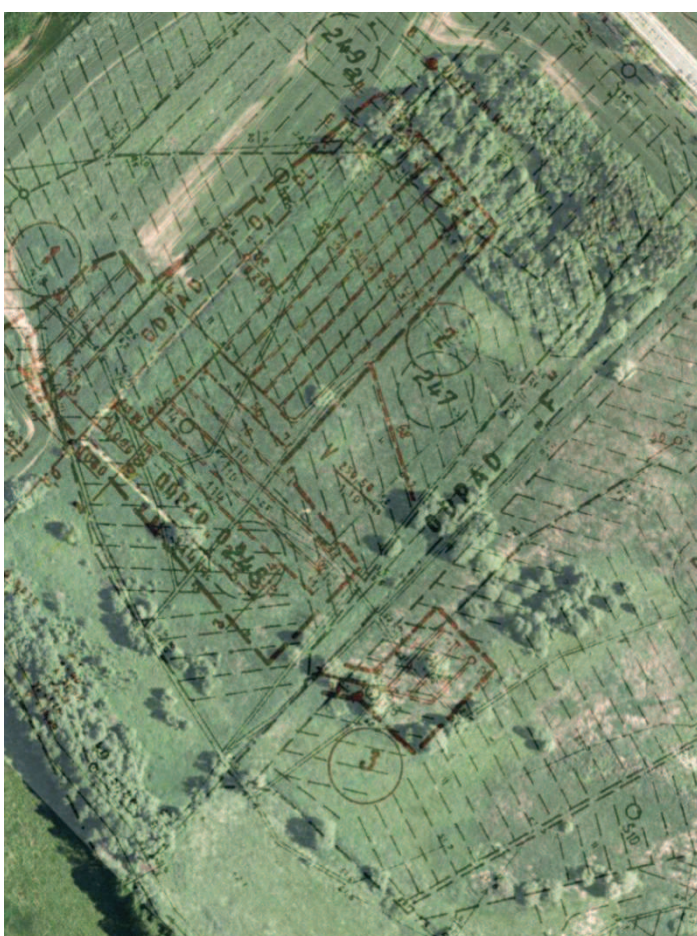
Obr. 14: Převedený zákres meliorací 1972–73 (červeně) z Obr. 15 (viz Přílohy) na ortofoto snímek v rozsahu západní části Sedmihorského mokřadu pomocí programu ArcGIS 10 (funkce „Georeferencing“) (PD-ML, 30 ).
