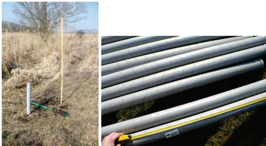
Obr. 28: Měření hladiny podpovrchové vody perforovanými trubkami. Foto: V. Šťastný.
