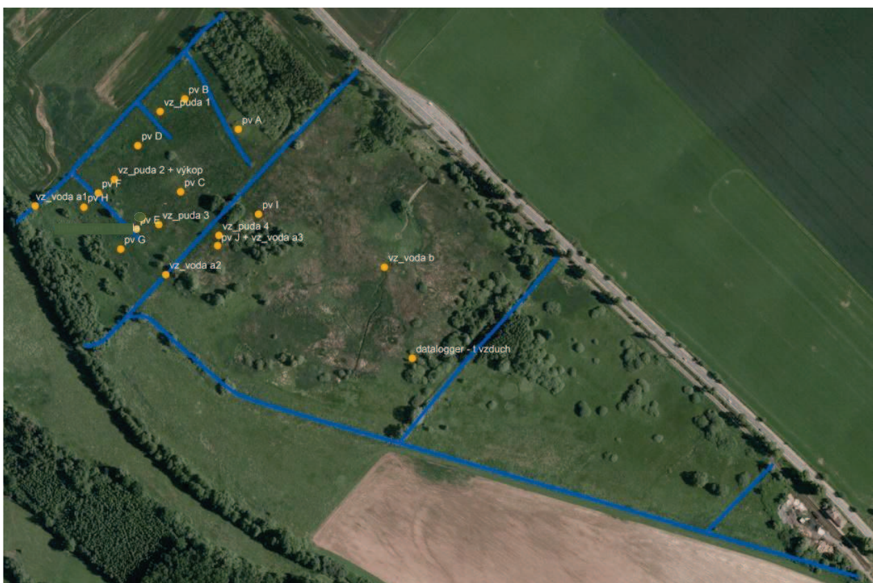
Obr. 26: Letecký snímek Sedmihorského mokřadu se zaměřenými GPS souřadnicemi bodů odběru vzorků vody (vz_voda) a půdy (vz_puda) a umístění sond pro měření hladiny podpovrchové vody (pv A–pv J) a dataloggeru v terénu. 30
