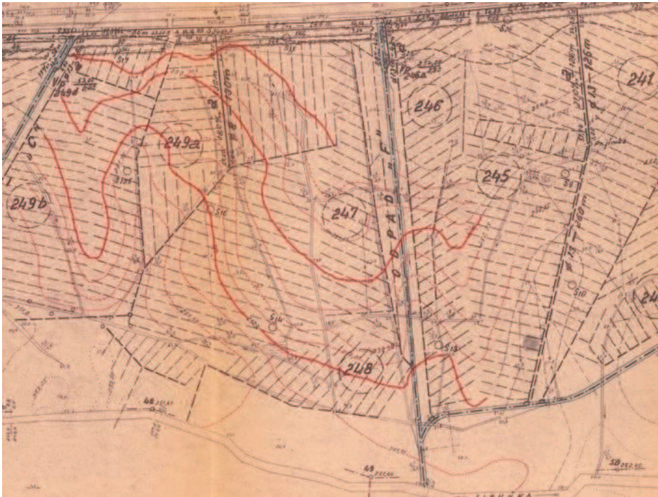
Obr. 6: Zákres vrstevnic na plánu stavby meliorací 1965–67 v rozsahu západní části Sedmihorského mokřadu (nahore silnice I/35, dole tok Libuňky) (PD-ML).
