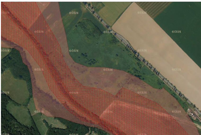
Obr. 16: Záplovová území při povodňových stavech Libuňky v oblasti Sedmihorského mokřadu – Q_5 (šrafovaně - zhruba v rozsahu toku Libuňky i s břehy), Q_{20} (šrafovaně) a Q_{100} (průhlednou barvou). 15
