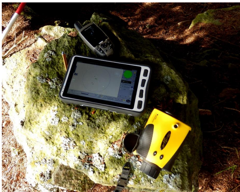
Obr. 8: Terénní počítač s programem FM Data Collector, laserový výškoměr TruePulse 360 a GPS.
