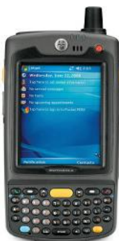
Obrázek 13: Přenosný počítač Motorola MC70, používaný pro odečty elektroměrů.
