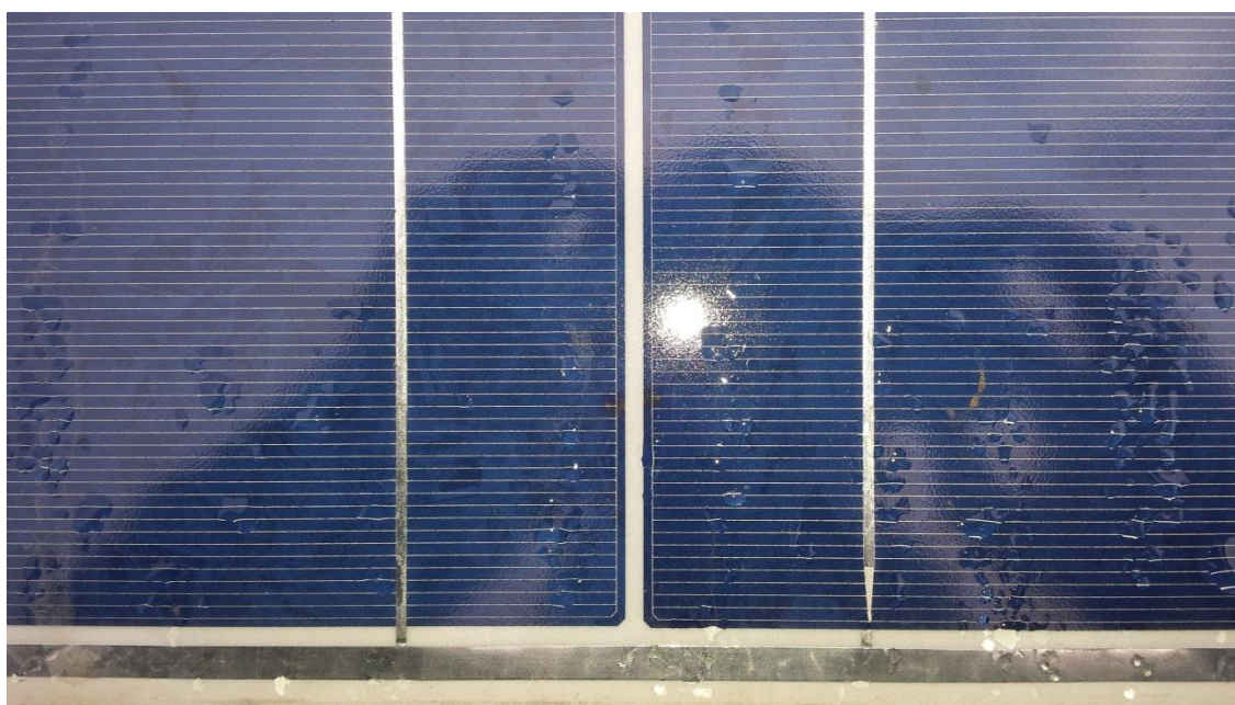
Obrázek 5: Detail panelu. Sběrné vodiče zastiňují nemalou část aktivní plochy.
