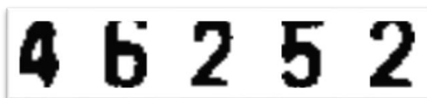
Obrázek 20- číslice separované z reálného elektroměru
