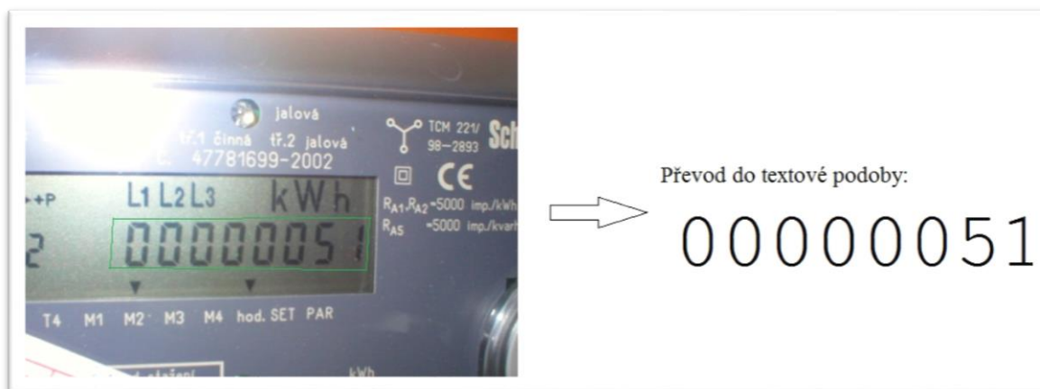
Obrázek 1 – převod obrázku elektroměru do textové podoby stavu elektroměru
