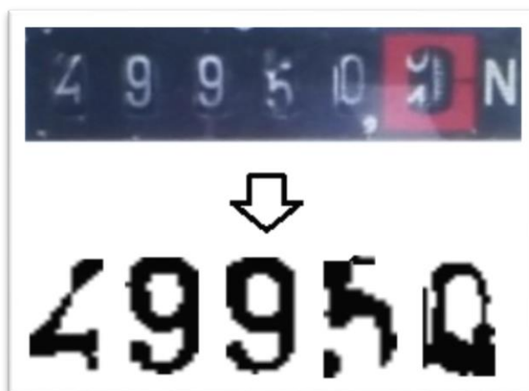
Obrázek 12- separované číslice analogového elektroměru
