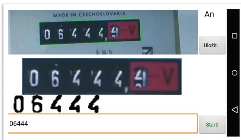
Obrázek 16 – mobilní aplikace při snímání analogového elektroměru
