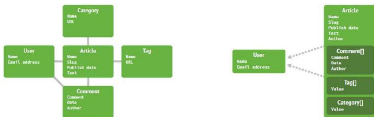
Obrázek 12 - Rozdíl v přístupu k vazbám u relačních a NoSQL databází 5
