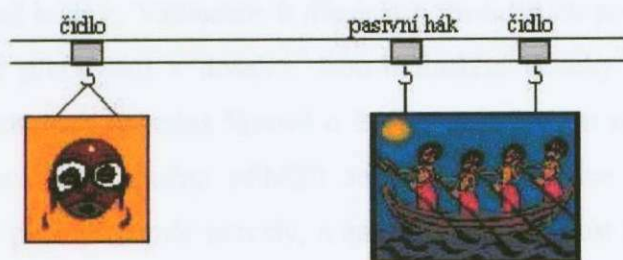
Obr. 6 Příklad použití závěsového čidla.
