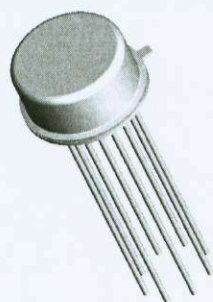
obr.2.20 – pouzdro IO – 7 a označení vývodů
