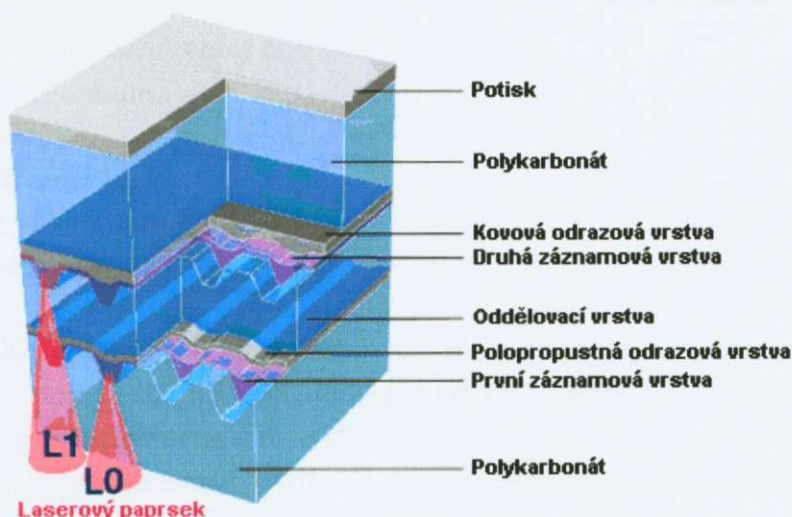
Obr. 2.5: Vrstvy dvouvrstvého DVD média. 17
