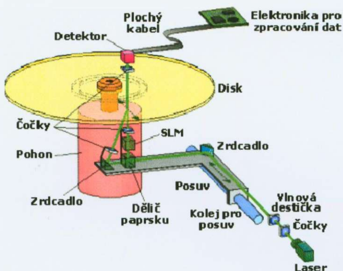
Obr. 7.4: Funkční holografická mechanika podle InPhase. 20
