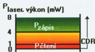
Obr. 1.14: Výkon laseru potřebný pro čtení a zápis u CD-R disků. 3
