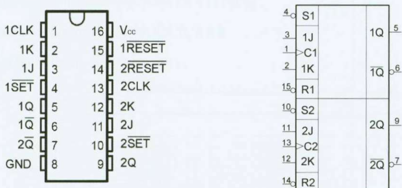
Obr. 4.15 Rozmístění vývodů a schématická značka IO 74112
