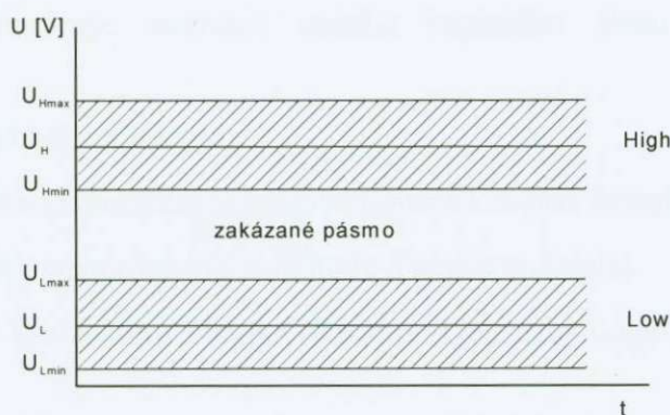
Obr. 1.8 Zakázané pásmo v logických úrovních
