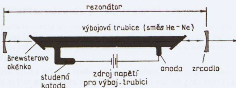
Obr 2.3. Princip provedení plynového laseru
