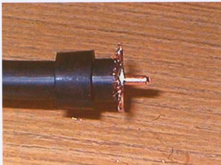
Obr. 27: Kabel připraven k pocínování a připájení Female trubičky.
