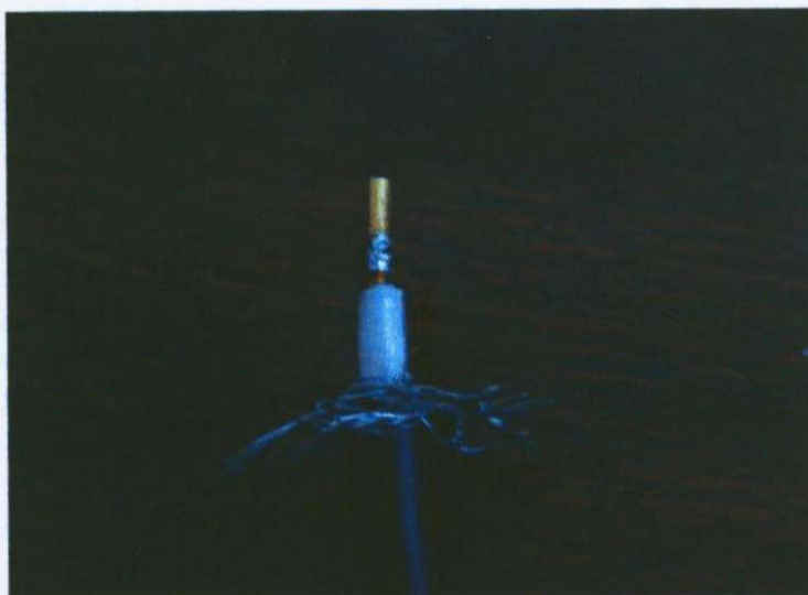
Obr. 40: LMR 195 a část SMA konektoru
