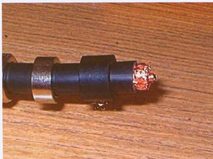
Obr. 24: první krok při výrobě N konektoru.
