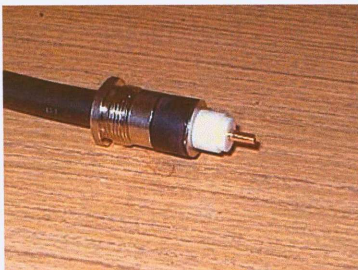
Obr. 29: Nasazení izolačního teflonového kroužku.
