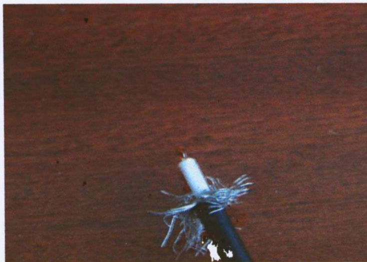
Obr. 38: Pocínování měděného jádra kabelu
