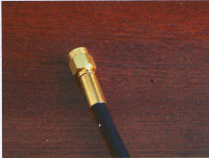
Obr. 43: Téměř hotový konektor připraven na namáčknutí krimpovacími kleštěmi
