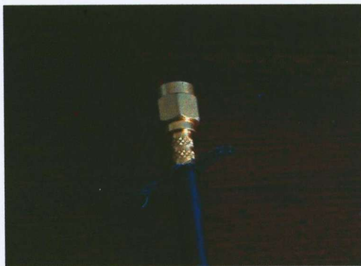
Obr. 41: Nasazená konektor SMA reverzní Female.
