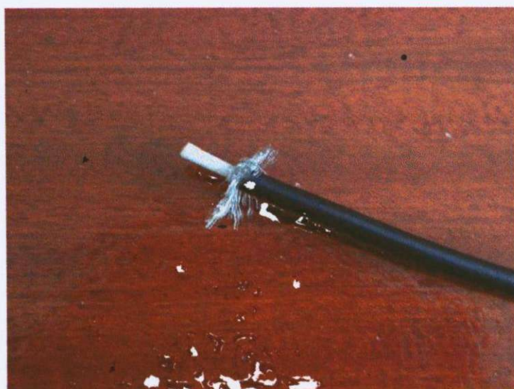
Obr. 36: Kabel LMR 195 s odstraněnou hliníkovou folií
