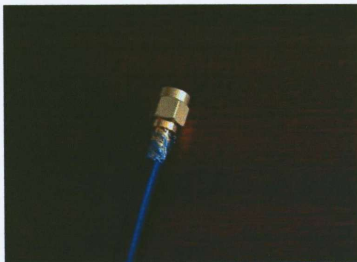
Obr. 42: Téměř hotový konektor - stínění obtočeno kolem konektoru
