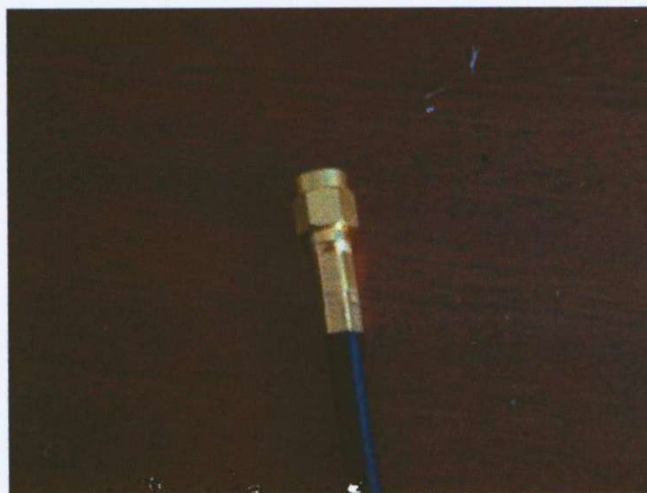
Obr. 45: Hotový konektor SMA reverzní Female
