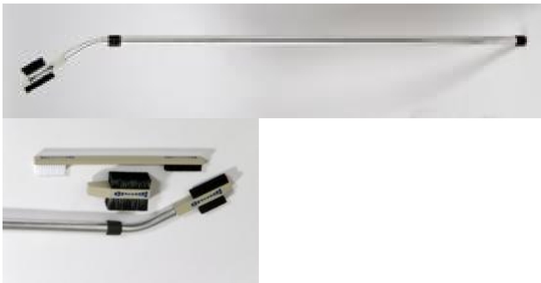
Obr. 47 Teleskopická tyč a kartáče pro čištění chytů
