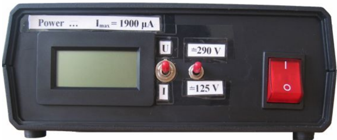
Obr. č. 17. Přední strana konstruovaného zdroje.
