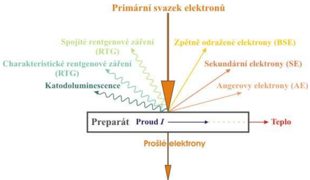
Obr. 6: Možné interakce elektronů se vzorkem
