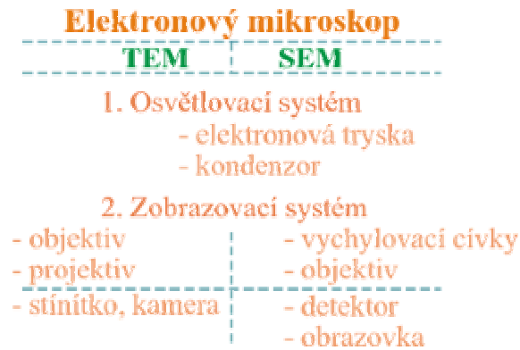
Obr. 33: Základní optické části elektronových mikroskopů
