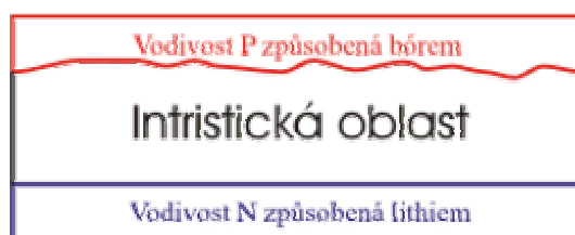
Obr. 60: Řez krystalem polovodiče kompenzovaného lithiem
