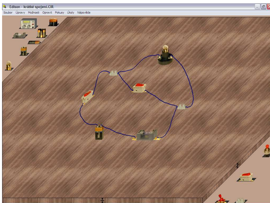
Obr. č. 4.1.2 Krátké spojení po spálení pojistky
