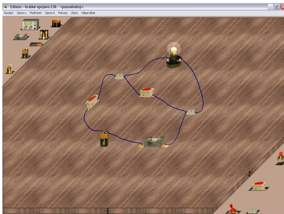
Obr. č. 4.1.1 Krátké spojení před spálením pojistky
