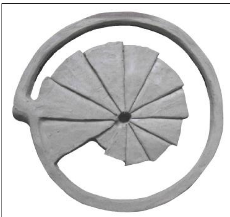
Nástěnné hodiny č.8 ze světlé kameniny, praskly při sušení
