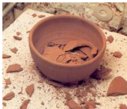
Obr.25. Roztržení výrobku při výpalu vinou vzduchové bubliny
