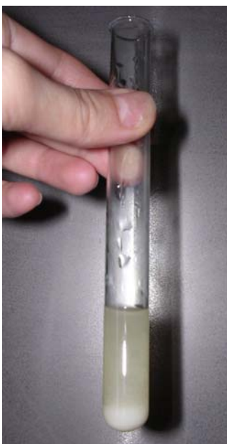
Obr. 44 Důkaz vápníku v podobě bílé sraženiny šřavelanu vápenatého
