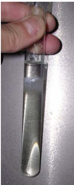
Obr. 55 Negativní výsledek na obsah dusičnanů v půdě
