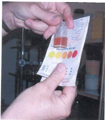
Obr. 57 Určení dusičnanů podle barevné škály a stupnice
