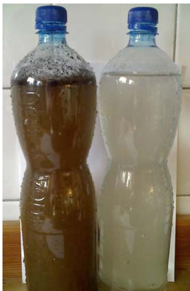
Obr. 79 Voda v láhvi s pískem (vpravo), voda s hlínou a jílem (vlevo)
