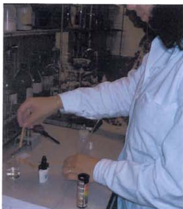
Obr. 34.1 Měření pH univerzálními indikátorovými papírkami
