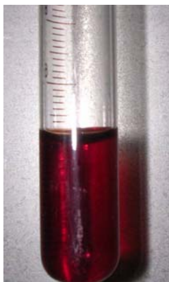
Obr. 49 Důkaz železa v podobě krvavě červeného zbarvení rhodanidu železitého
