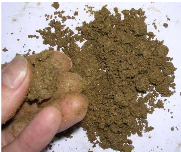
Obr. 25 Prstová zkouška ke stanovení půdní vlhkosti vzorku půdy dle Novákovy stupnice
