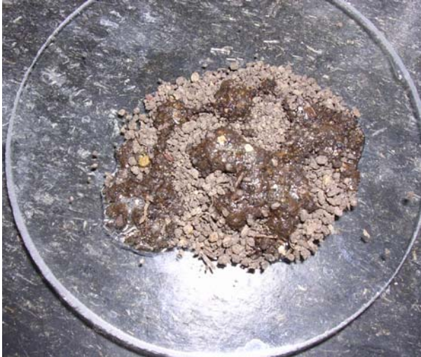
Obr. 42 Šumění půdy působením HCl
