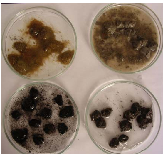
Obr. 23 Rozpadání drobtů jednotlivých vzorků půdy (nahore zleva doprava–písečná, jílovitá, dole zleva doprava–zahradnický substrát, hlinitá půda)
