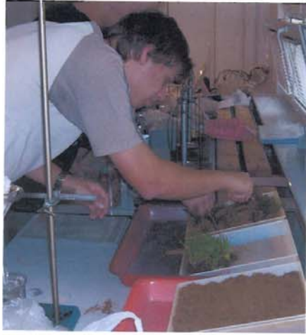
Obr. 73 Plnění fotografických misek pro účel vodní eroze
