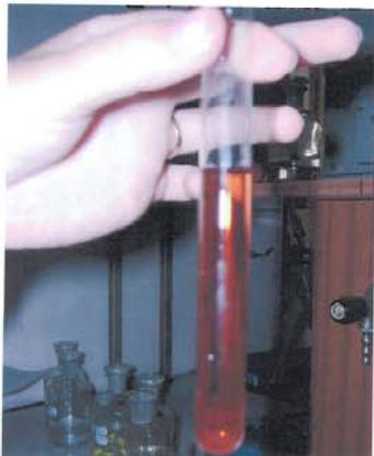
Obr. 50 Důkaz železa v podobě červeného roztoku rhodanidu železitého
