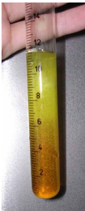
Obr. 53 Důkaz fosforu v podobě žluté sraženiny fosfomolybdenanu amonného
