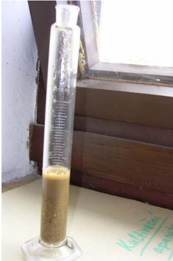
Obr. 18 Sedimentace vzorku písku ve válci s broušenou zátkou
