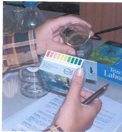
Obr. 39 Zjištění pH porovnáním barvy roztoku s barevnou stupnicí
