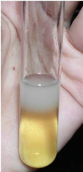
Obr. 46 Důkaz vápníku v podobě bílé sraženiny síranu vápenatého
