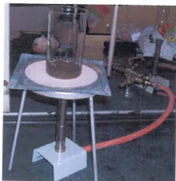
Obr. 45.1 Zahřívání jemnozeme s 5% HCl
