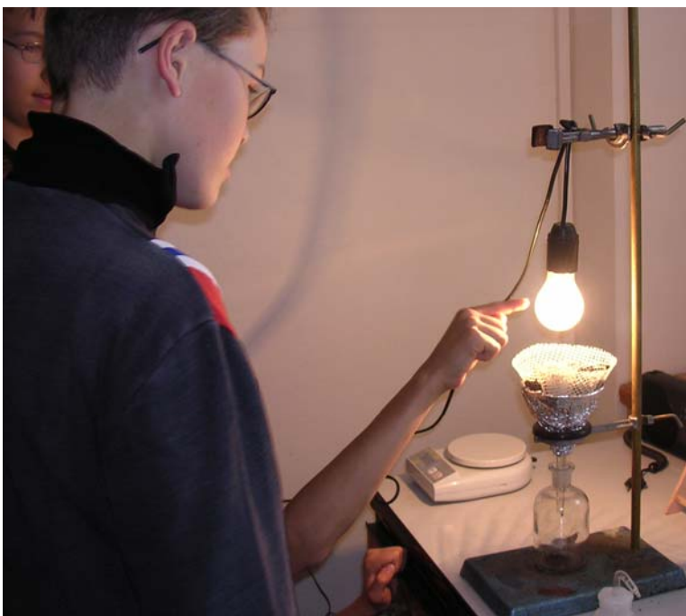
Obr. 66 Přístroj na vyhánění živočichů z půdy (na gymnáziu)
