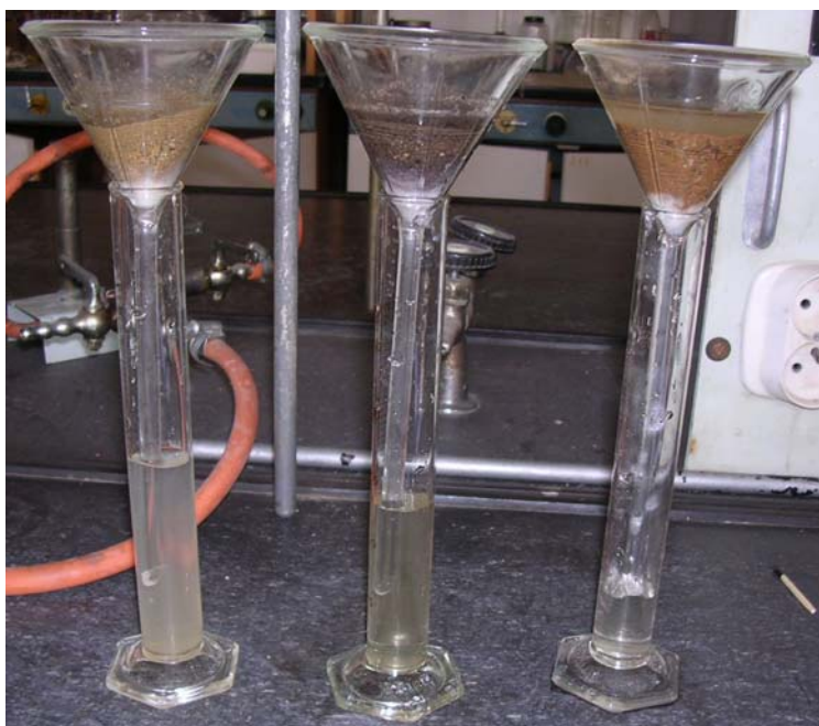
Obr. 20 Propustnost různých druhů půd pro vodu (zleva-doprava písčité, hlinitá, jílovitá)
