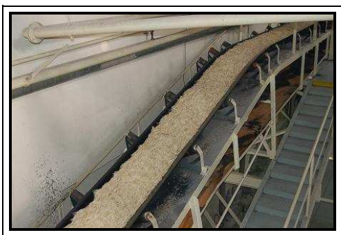
Obrázek 20. Pásové dopravníky řízků
