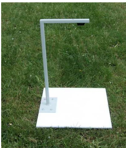
Obr. č. 34: Snímek sněhoměru bez ochranného krytu senzoru
