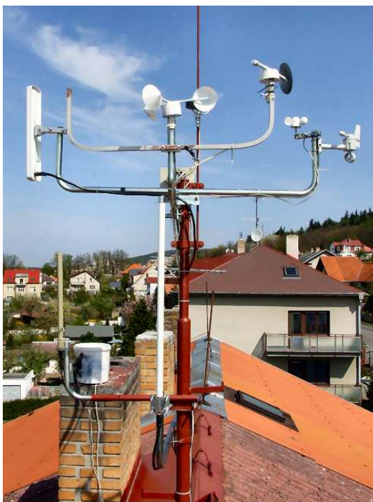
Obr. č. 12: Fotografie stožáru s čidly rychlosti a směru větru a slunečního osvětlení
