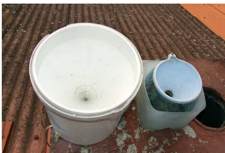
Obr. č. 29: Srážkoměry umístěné na komínu domu
