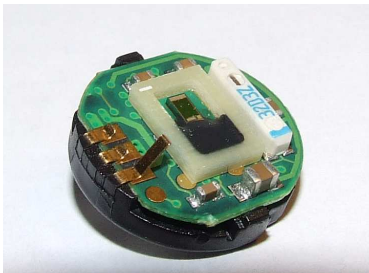
Obr. č. 9: Vnitřní uspořádání datalogeru teploty a vlhkosti DS1923
