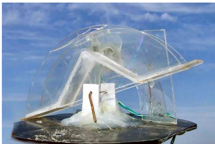
Obr. č. 28: Fotografie člunku srážkoměru
