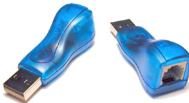
Obr. č. 5: Adaptér DS9490R s obvodem DS2490 pro USB
