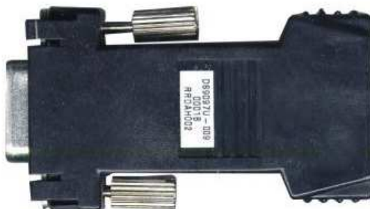
Obr. č. 6: Adaptér DS9097U-009 s obvodem DS2480B
