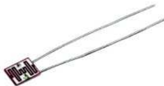
Obr. 6 Fotoresistor FW150 · R10*(kOhm): 28,0 · R01* (kOhm): 1,40 · R05*(kOhm): 4,20 · Vmax(V): 150 · Pmax (mW): 250 · tan t(ms): 35 · tab(ms): 28FW 150 R10 [11]
