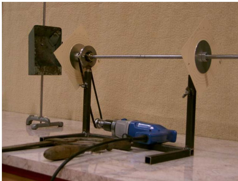
Obr. č. 5.2.1 Kotoučová aparatura na měření rychlosti střely a lapač střel (vlevo)
