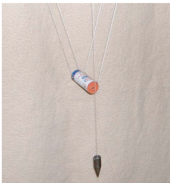
Obr. č. 1.1 Vyvážení kyvadla pomocí olovnice
