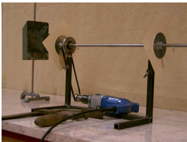
Obr. č. 1 Kotoučová aparatura a lapač střel (vlevo)
