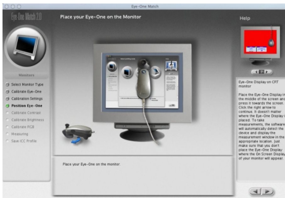
Obr. 21: Objektivní kalibrace a charakterizace monitoru pomocí Eye-One Match firmy X-Rite.
