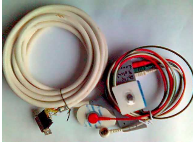
Obr. č. 23 - Zapojení snímacích EKG elektrod pomocí originálních kabelů
