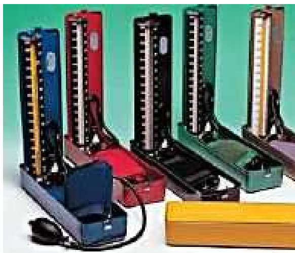
Obr. č. 1 - Rtuťový tlakoměr
